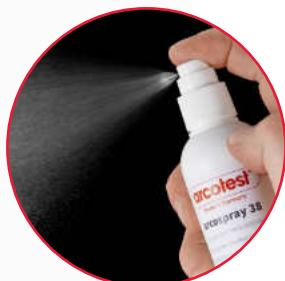
L'inchiostro di prova arcospray® 38 è un liquido di prova con tensione superficiale di 38 mN/m. È stato sviluppato per analizzare rapidamente l'assenza di grasso su una superficie, in quanto è possibile presumere che a partire da questo valore la superficie sia priva di grasso. arcospray® 38 può essere rimosso senza residui dopo l'applicazione soffiando d'aria pulita e priva di grasso (aria compressa).
